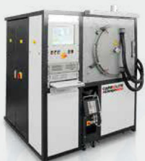
Рис. 3: Печь для удаления связующих веществ EVO
